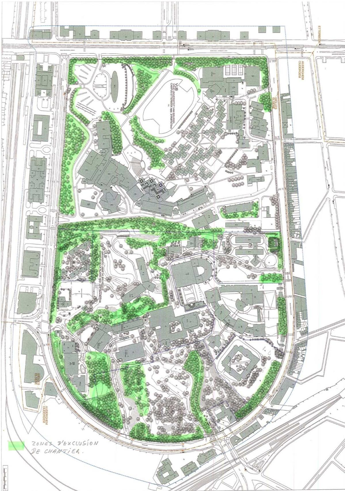
Figure 143: zones d'exclusion de chantier (Source: PROSPECT C&S)
